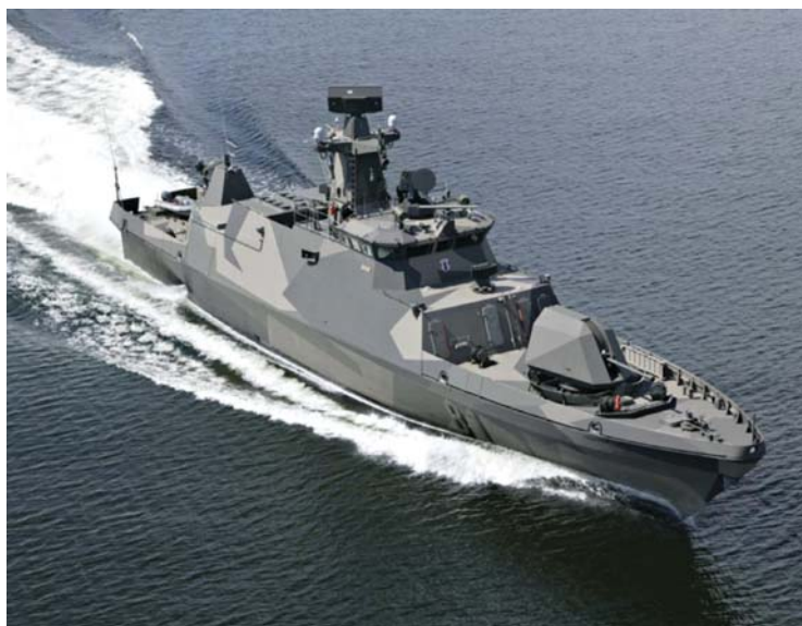
Финска корветсa FNS 81 Tornio класе Hamina – ракеџе Umkhonto-IR Block 2 се налазе у вертикалним лансерима иза командног мостсa брода
